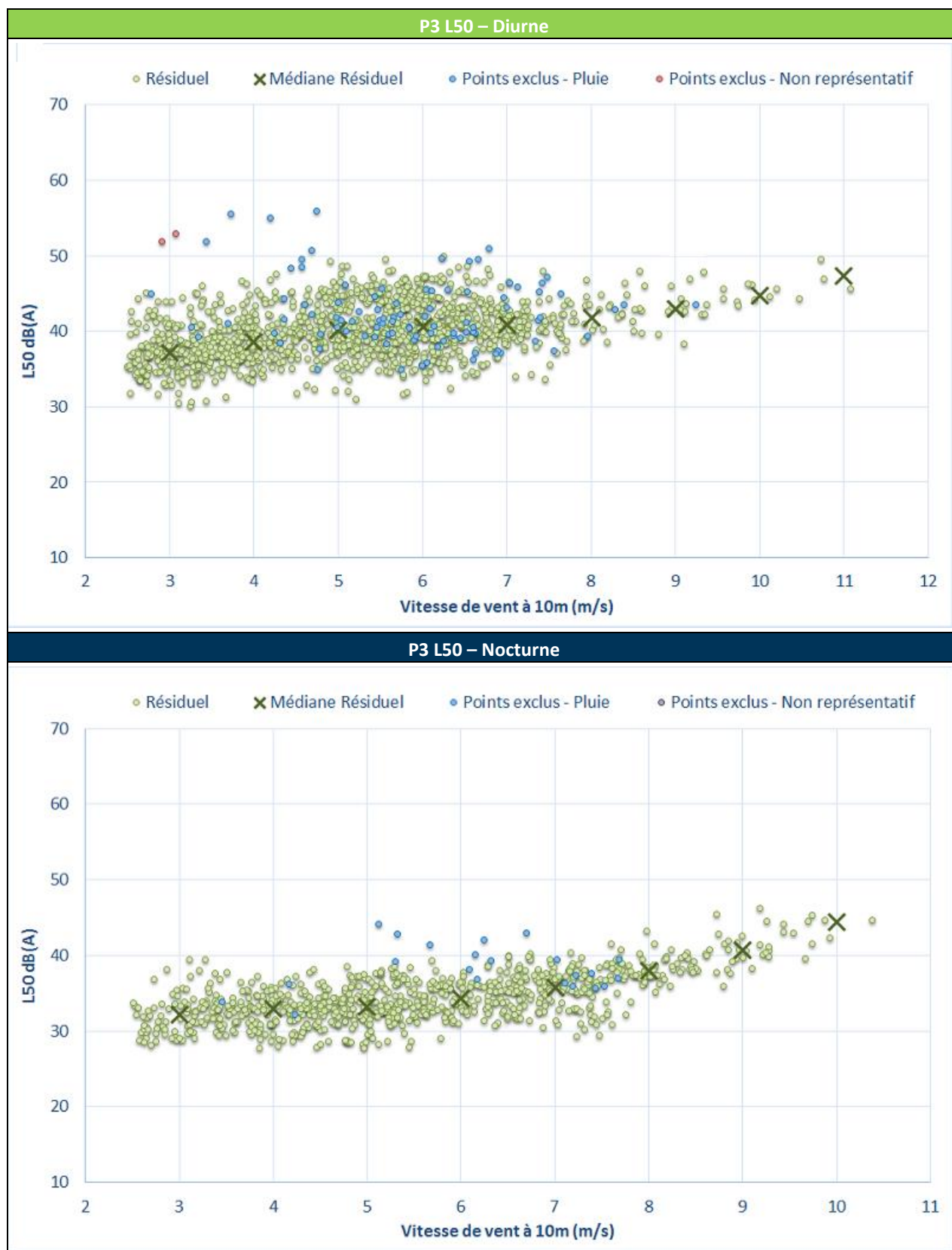
Figure 8 : Bruit en fonction de la vitesse de vent au point P3
