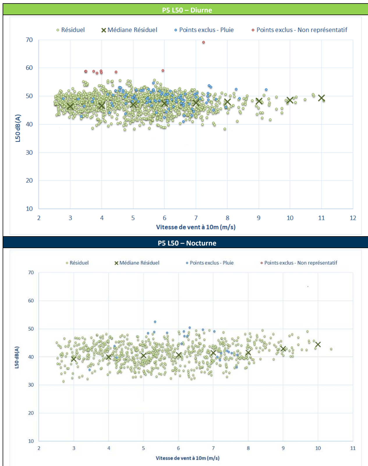
Figure 10 : Bruit en fonction de la vitesse de vent au point P5
