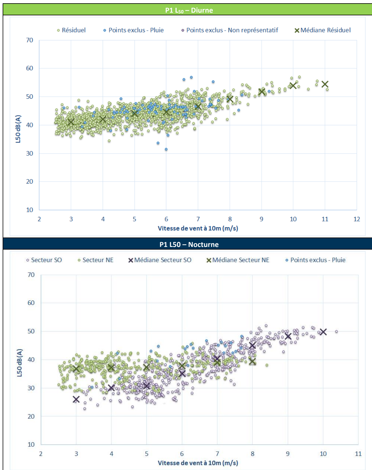
Figure 6 : Bruit en fonction de la vitesse de vent au point P1
