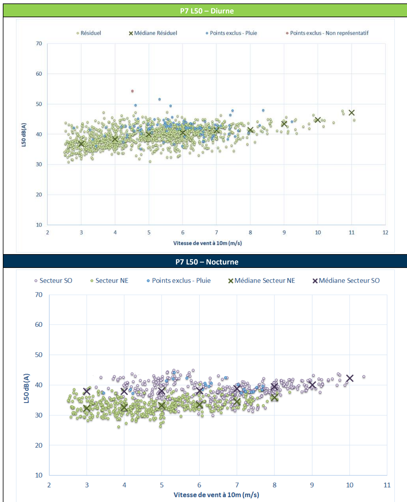
Figure 12 : Bruit en fonction de la vitesse de vent au point P7
