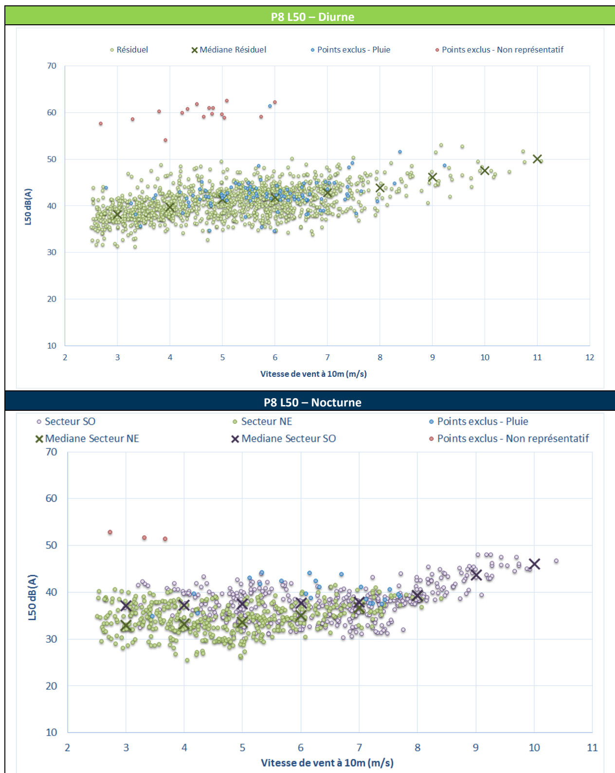
Figure 13 : Bruit en fonction de la vitesse de vent au point P8
