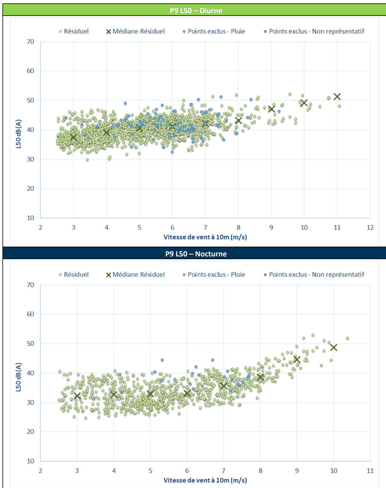
Figure 14 : Bruit en fonction de la vitesse de vent au point P9
