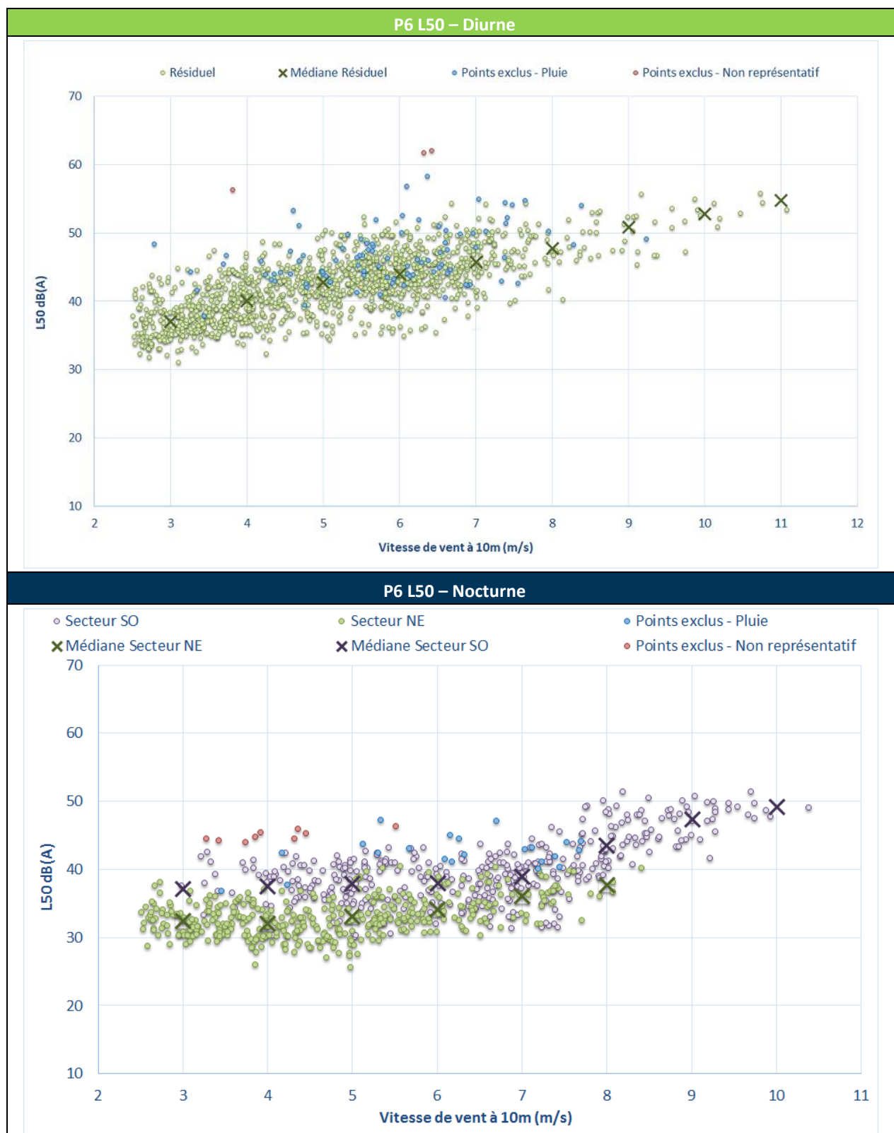
Figure 11 : Bruit en fonction de la vitesse de vent au point P6
