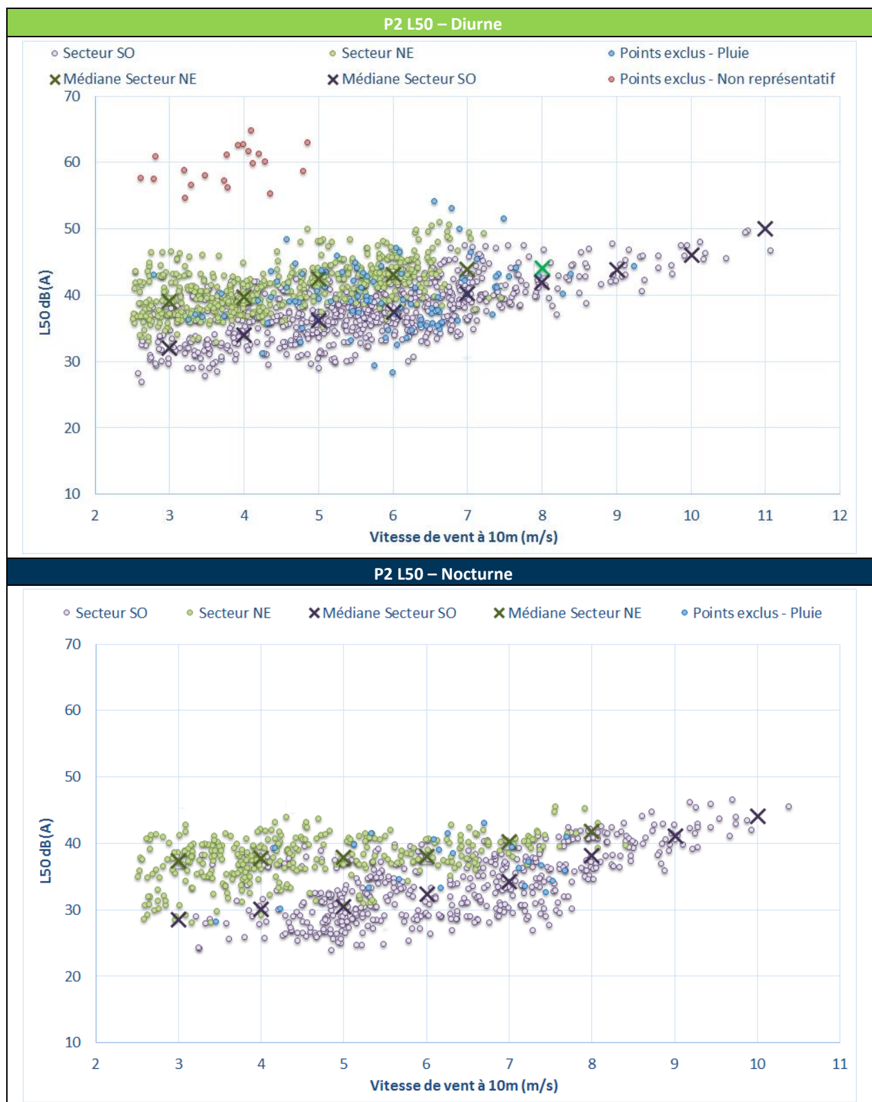
Figure 7 : Bruit en fonction de la vitesse de vent au point P2
